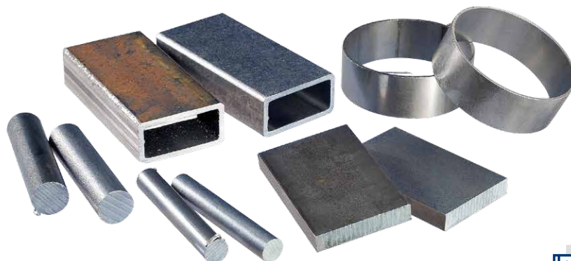
Sinistra: senza trattamento, destra: con trovalizzazione
