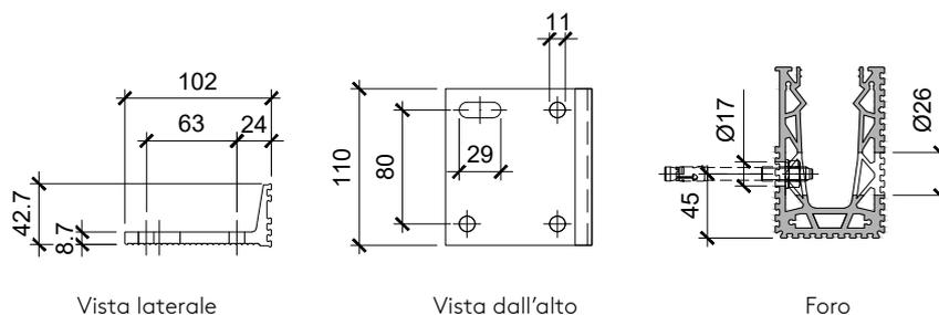
Per fissare le mensole alla sottostruttura possono essere utilizzati gli ancoranti Fischer specificati o ancoranti equivalenti conformi all'omologazione tecnica europea ETA-07/0025 o ETA-05/0069. Devono essere rispettati i requisiti di questa omologazione tecnica europea. Qualità del calcestruzzo almeno C20/25 (calcestruzzo fessurato). I predimensionamenti non sostituiscono i calcoli statici specifici dell'immobile. Si applicano le norme, le prescrizioni e i regolamenti edilizi nazionali.
