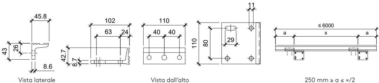
Per fissare le mensole alla sottostruttura possono essere utilizzati gli ancoranti Fischer specificati o ancoranti equivalenti conformi all'omologazione tecnica europea ETA-07/0025 o ETA-05/0069. Devono essere rispettati i requisiti di questa omologazione tecnica europea. Qualità del calcestruzzo almeno C20/25 (calcestruzzo fessurato). I predimensionamenti non sostituiscono i calcoli statici specifici dell'immobile. Si applicano le norme, le prescrizioni e i regolamenti edilizi nazionali.
